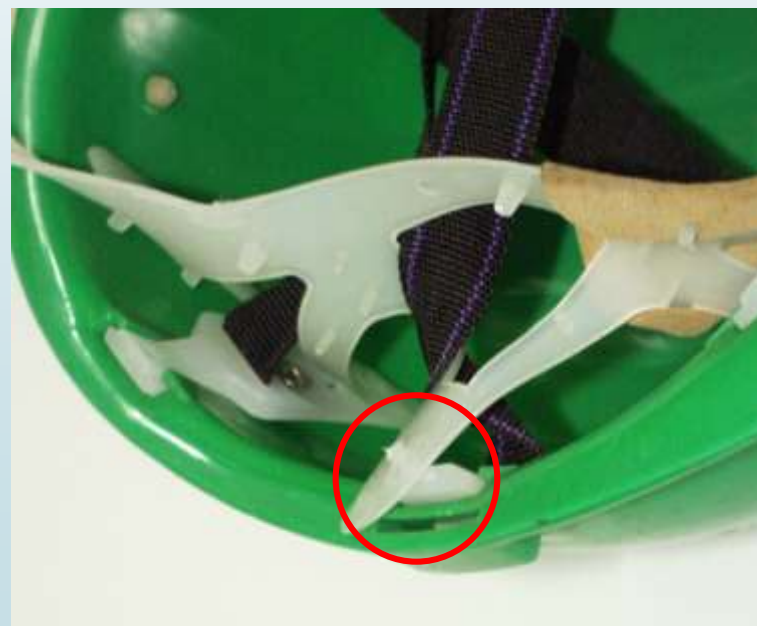
Rys. 17. Uszkodzenia regulatorów wysokości noszenia
