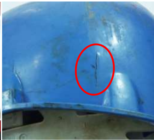
Rys. 2. Pęknięcia skorup hełmów
