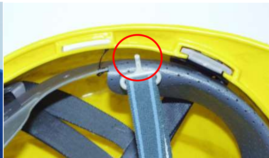
Rys.19. Uszkodzenia punktów mocowania paska podbródkowego
