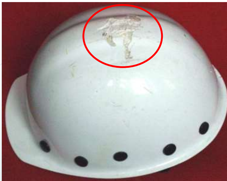
Rys. 6. Odpryski o dużej powierzchni materiału skorupy
