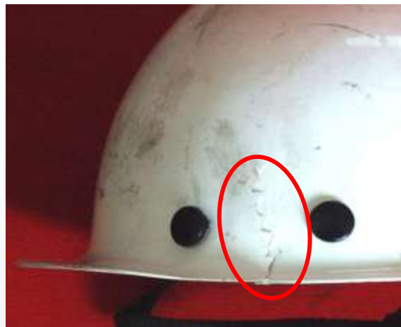
Rys. 2. Pęknięcia skorup hełmów
