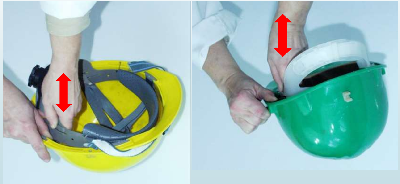
Rys. 13. Sprawdzanie połączenia pasa głównego ze skorupą hełmu
