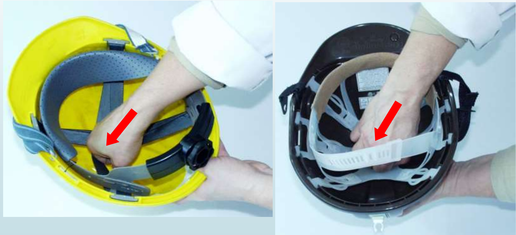
Rys. 8. Sprawdzanie więźby hełmu
