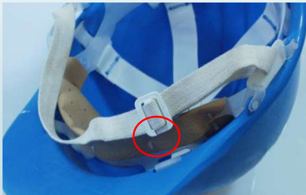
Rys.19. Uszkodzenia punktów mocowania paska podbródkowego
