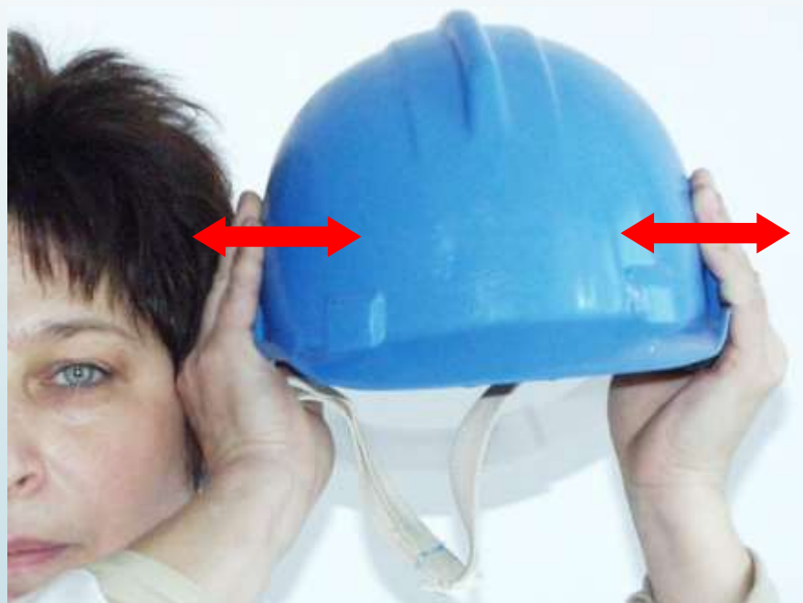
Rys. 1. Sprawdzanie trzeszczenia skorupy hełmu
