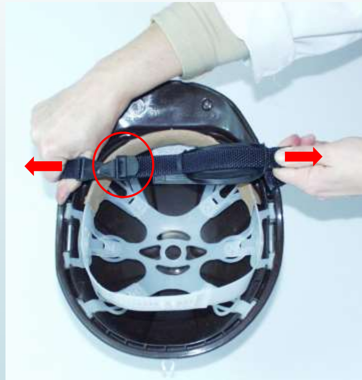
Rys. 18. Sprawdzanie regulatora paska podbródkowego
