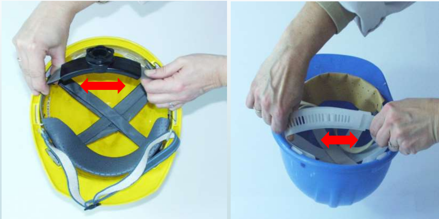
Rys. 14. Sprawdzanie trwałości nastawy długości pasa głównego ze skorupą hełmu
