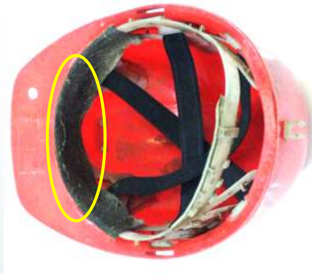
Rys. 16. Silne zabrudzenie potnika
