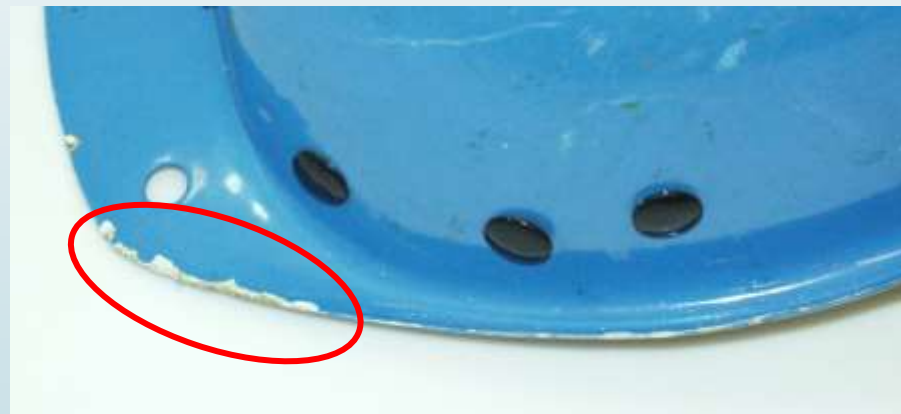
Rys. 7. Poszczerbienia brzegu skorupy
