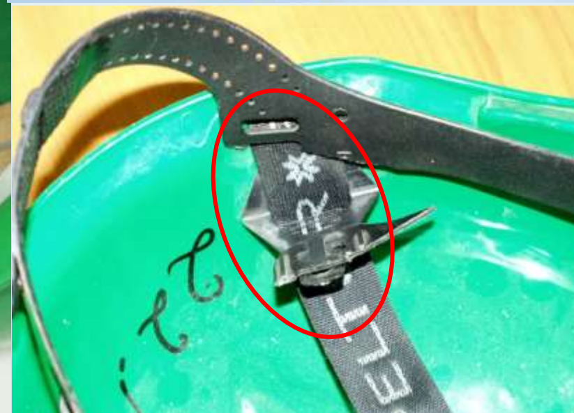
Rys. 17. Uszkodzenia regulatorów wysokości noszenia
