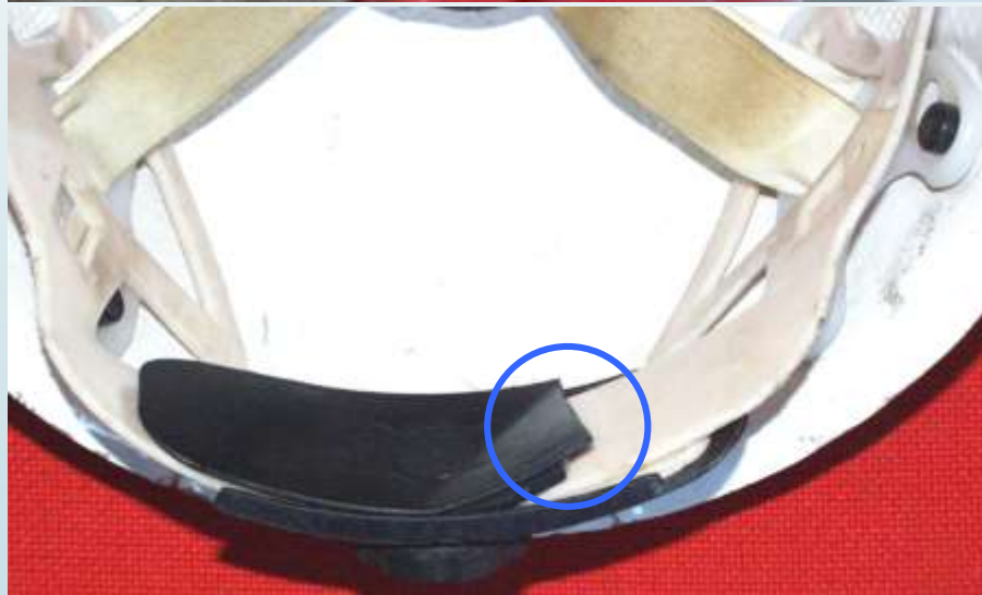
Rys. 15. Uszkodzenia regulatorów długości pasów głównych
