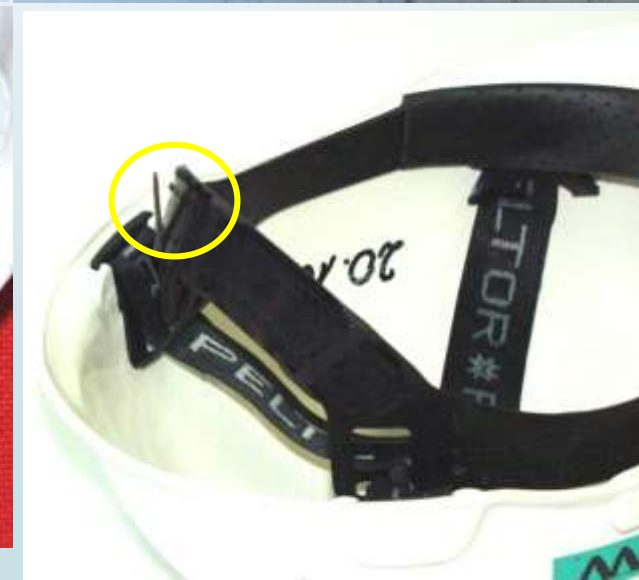
Rys. 15. Uszkodzenia regulatorów długości pasów głównych
