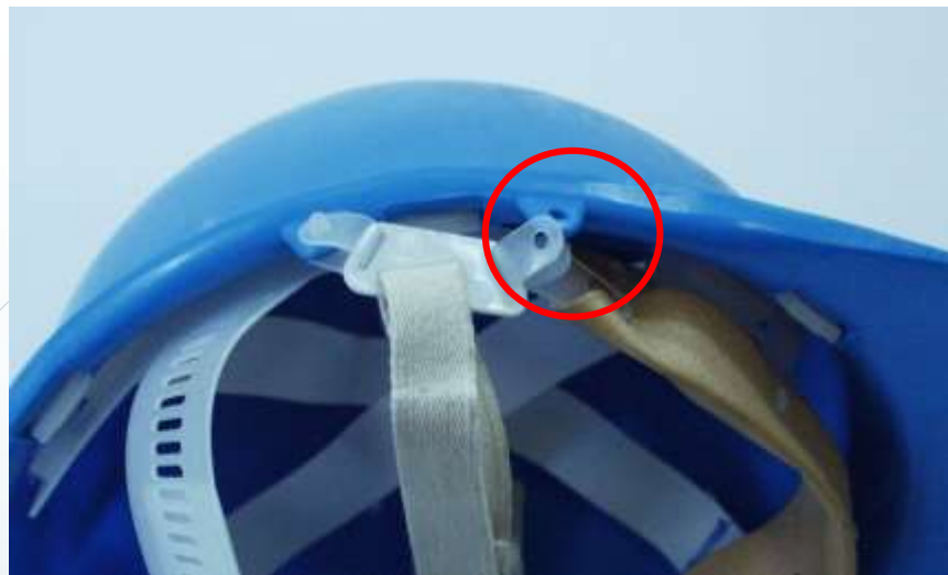
Rys.19. Uszkodzenia punktów mocowania paska podbródkowego
