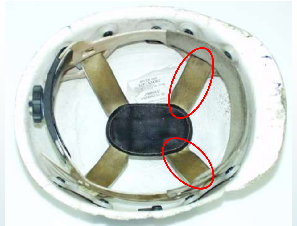
Rys. 12. Silne zabrudzenia taśm więzby
