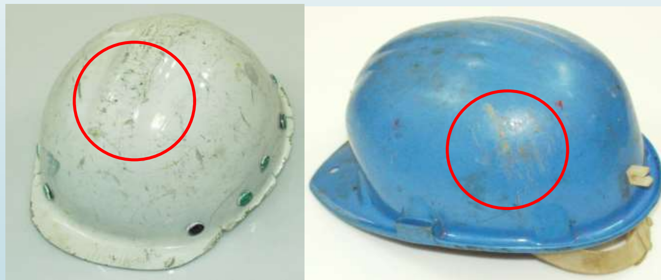
Rys. 5. Przebarwienia i głębokie obtarcia powierzchni skorupy hełmu
